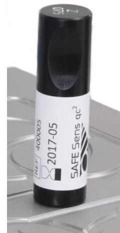
SAFE Sens® qc 2 -Kalibrierungstool auf sv 2 -Sensor eines TrakPods™ im Benchtop-Inkubator Labo C-Top
