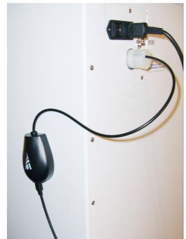
SAFE Sens® TrakPod™ installiert im 200 l-Inkubator Labo C201 mittels Access Port
