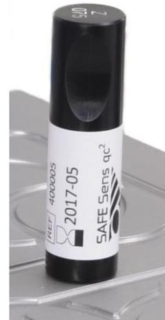
SAFE Sens® qc<sup>2</sup>-Kalibrierungstool auf sv<sup>2</sup>-Sensor eines TrakPods™ im Benchtop-Inkubator Labo C-Top
