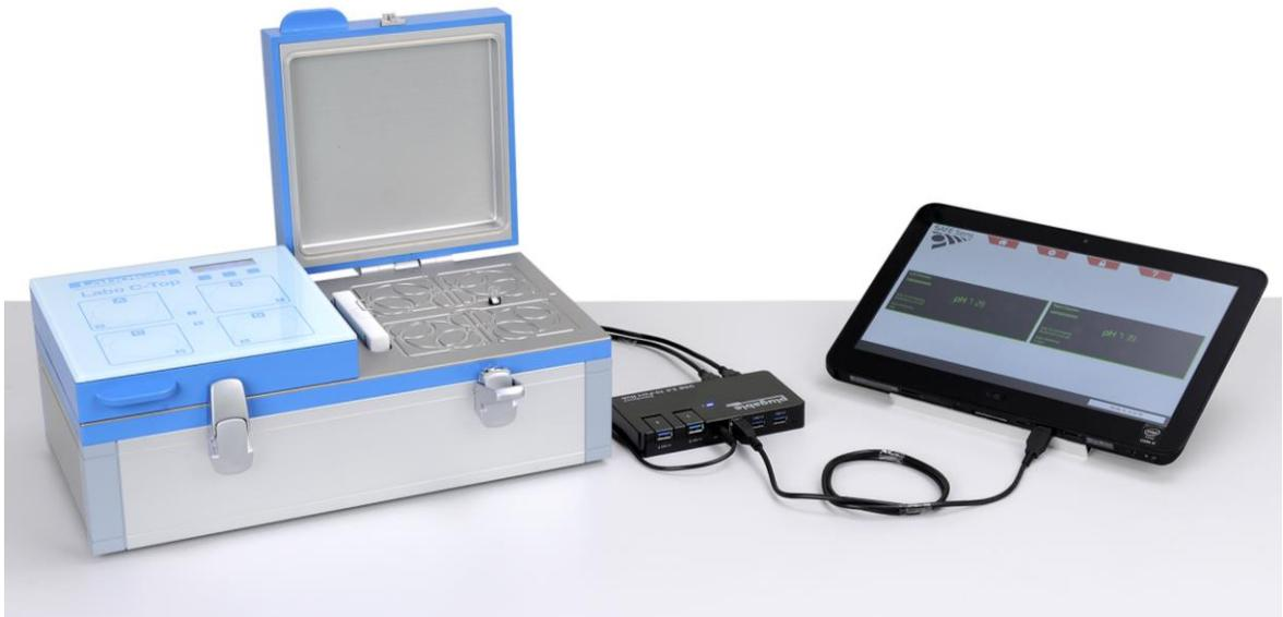
**Benchtop-Inkubator mit integrierter SAFE Sens® Technologie für kontinuierliche, nicht-invasive pH-Wert-Überwachung**
