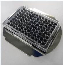
Tablar für Mikrotiterplatten für Einsatz REF 17662
