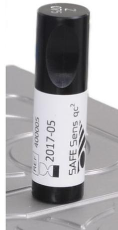
SAFE Sens<sup>®</sup> qc<sup>2</sup>-Kalibrierungstool auf sv<sup>2</sup>-Sensor eines TrakPods<sup>™</sup> im Benchtop-Inkubator Labo C-Top
