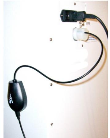
SAFE Sens<sup>®</sup> TrakPod<sup>™</sup> installiert im 200 I-Inkubator Labo C201 mittels Access Port
